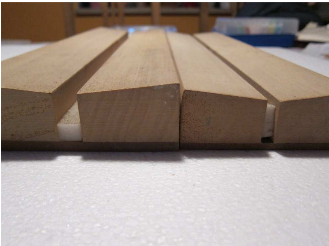
Vergleich 12mm-Nut (links) zu 7mm-Nut (rechts)
